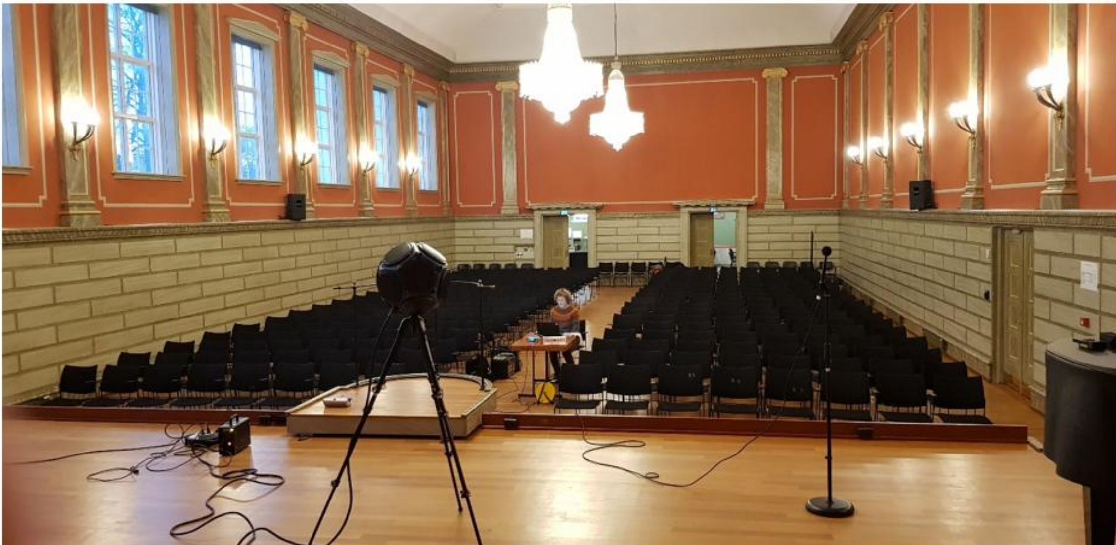
Bilde 2 - Bildet er tatt under siste kontrollmåling etter at akustikkpuss er påført på bakvegges gesims.
