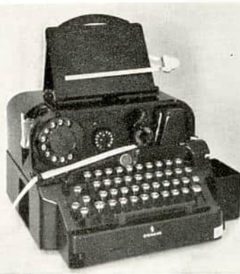
Til venstre: Tonetelegrafsystem for overføring av inntil 24 kanaler på en telegraflinje. — I midten: Kombinert håndperforator og automatsender for fjernskriveranlegg. — Til høyre: Fjernskriver og sentralbord for automatisk valg av abonnent.
