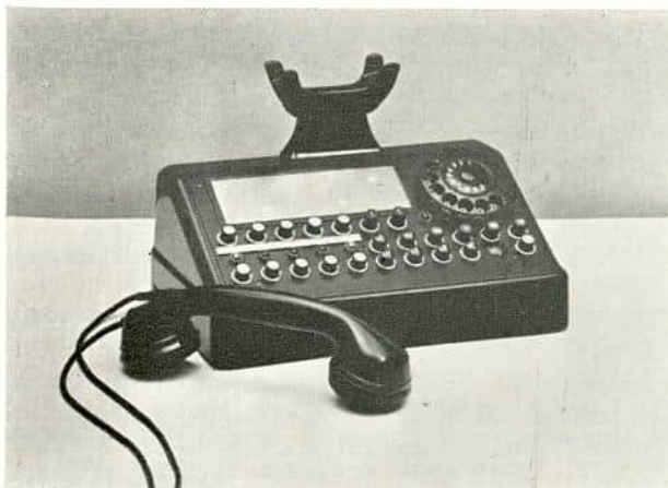
Betjeningsapparat for en PABX-sentral (hustelefonanlegg) med motorvelgere og opptattlampefelt.
