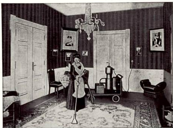
Fig. 1. »Liten kjørbær pumpe for støvfjerning« fra 1906. Den veide ca. 150 kg.
