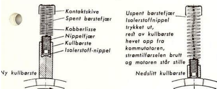
Fig. 8. Virkemåten til de automatiske kullbørstene fra Siemens.
