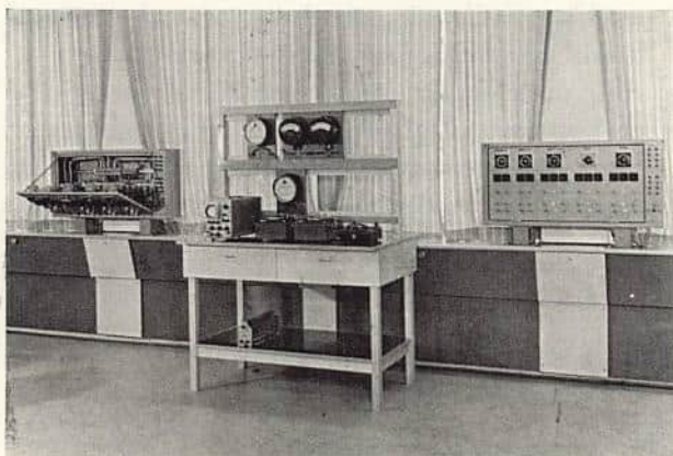
Arbeidsplassstavler i sterkstrømslaboratoriet. Den venstre tavlen er åpnet.
