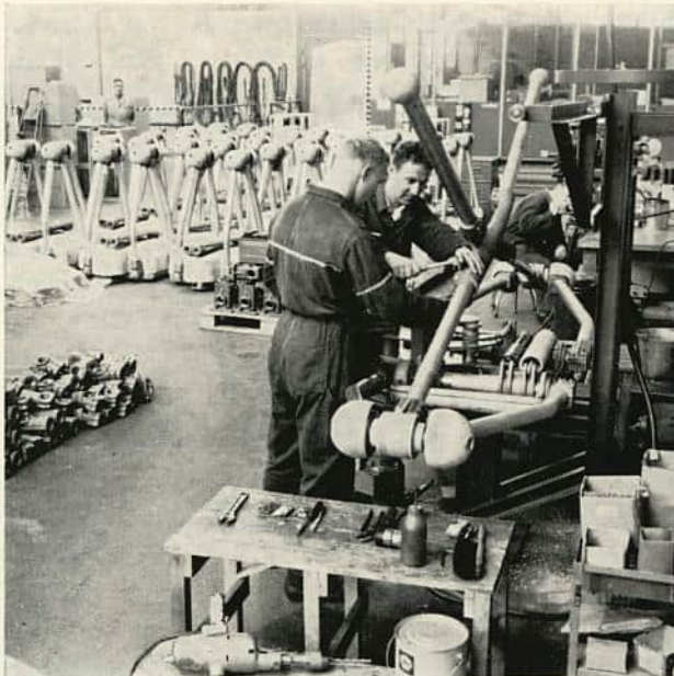
Vi ser her i forgrunnen prøvestasjonen for pantografbrytere, hvor hver bryter blir justert og prøvet mekanisk. I bakgrunnen «sakser» klar for emballering.
