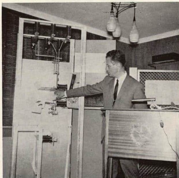
Ingeniør G. Hansen demonstrerer og holder foredrag om høyspenning lastbryter.
