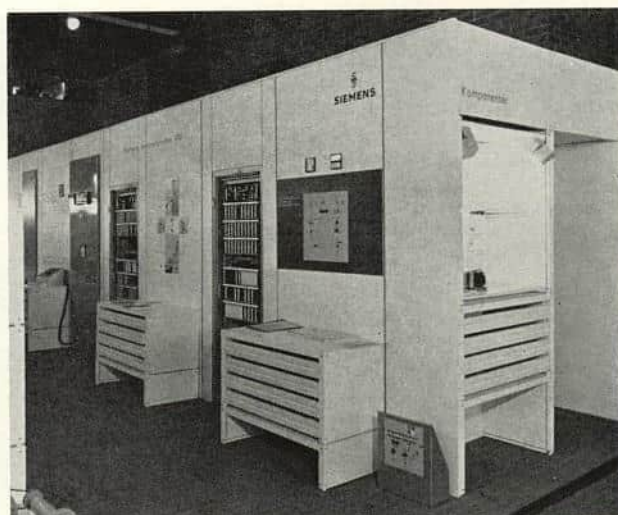
Mosaikketavlen og elektronisk fjernkontrollsystem med sentral og understasjon. Innfelt i døren i skapet bak, skimter vi øverst KONINK-KONGIK og derunder det elektroniske meldesystem.
