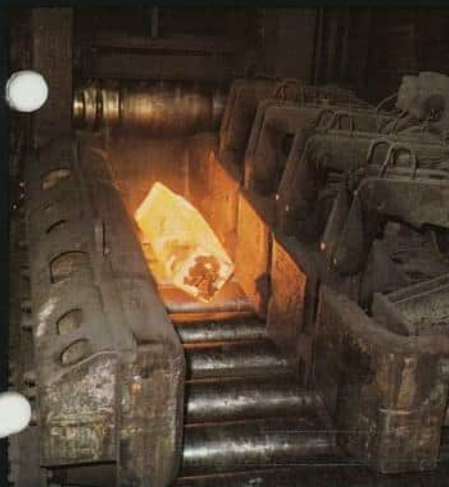
Grovvalsing ved Norsk Jernverk. Automatisering øket produktiviteten og ga mindre vrak enn før.
