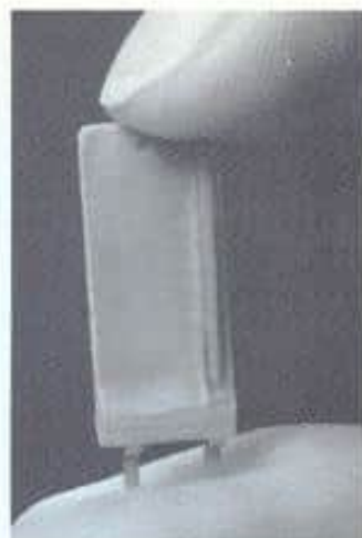
Denne lille tynne platen er kjernen i den nye elektroniske trykknappbryteren.
