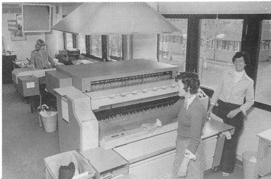
Denne helautomatiske lyskopieringsmaskinen tar formater opp til 1,22 x 0,86 m. Lilian Andersen, Gunvor Øverås og Grethe Martinsen (t.h.) slipper nå å brette kopiene for hånd.
