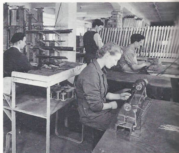
Fra produksjonen på Vegar i 1950-årene. Doris Kjørbu i forgrunnen spinner hetespiraler, en operasjon som idag utføres automatisk.
