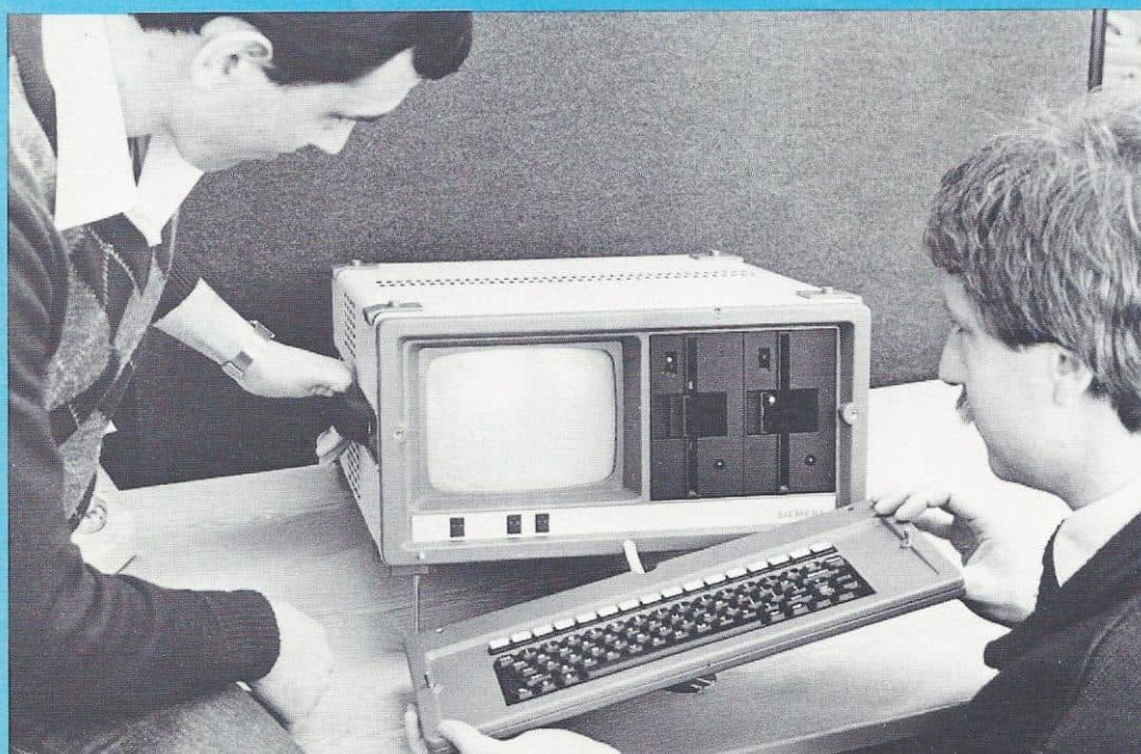
PMS, Portable Microcomputer System. Bare 21 kg veier dette anlegget som bl.a. har to floppy med hver 180 KByte hukommelse.
