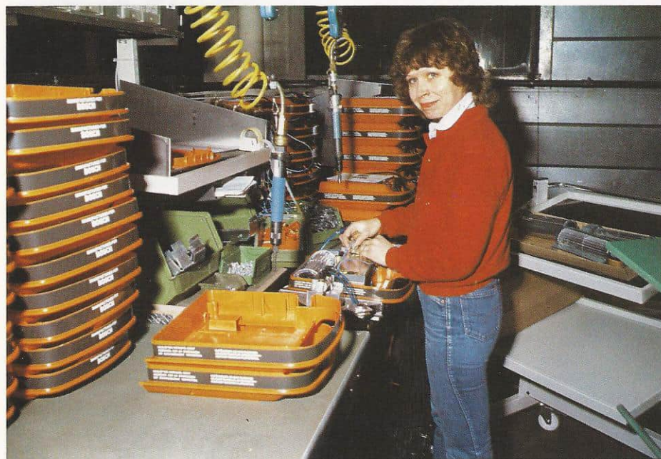
Brit Lund er en av dem som har fått arbeidet med sluttmontasjen av den nye bilkupé-ovnen i Elektrovarmefabrikken.
