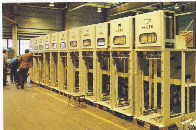
Nordsjøvirksomheten skaper arbeidsplasser i Sterkstrømfabrikken i Trondheim. Til venstre 13,8 kV effektbryterceller 8 BD 1 for levering til Gullfaks A. Til høyre deler av S 404 tavler for Kårstøanlegget
