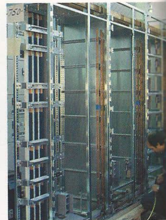
Nordsjøvirksomheten skaper arbeidsplasser i Sterkstrømfabrikken i Trondheim. Til venstre 13,8 kV effektbryterceller 8 BD 1 for levering til Gullfaks A. Til høyre deler av S 404 tavler for Kårstøanlegget
