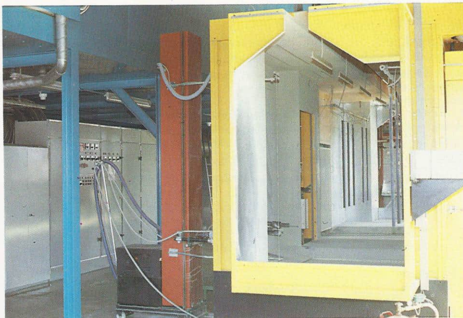
Lakkering – før og nå: Til venstre Eivind Haarberg som svinger den gode gamle sprøytepipstolen – til høyre et inntrykk av de maskinelle installasjoner som er nødvendig for å erstatte mannen med sprøytepipstolen.
