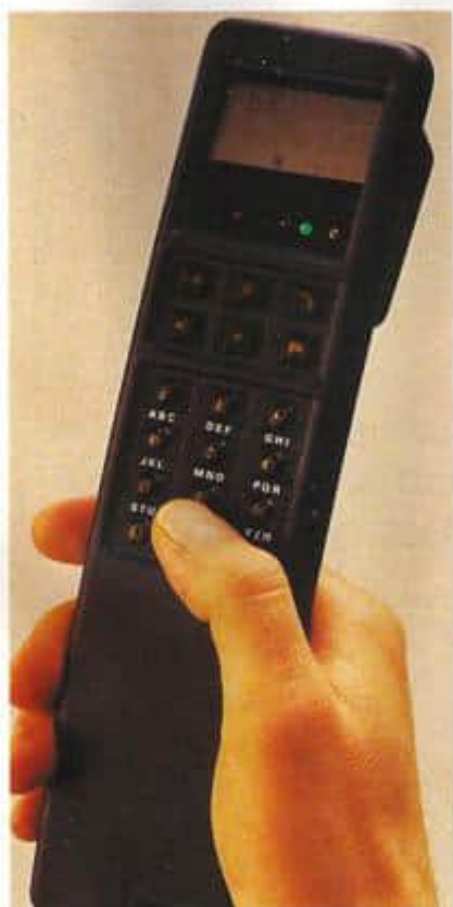
Siemens mobiltelefon 2. generasjon – med display hvor navn kan settes inn i stedet for nummer. Produksjonen av mobiltelefon skal i løpet av året overtas av Siemens i Vest-Tyskland, men salget i Norge skal naturligvis fortsette som før.
