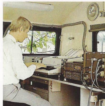
Kortbølge feltradiostasjon av den type Siemens skal levere til Forsvaret i løpet av årene som kommer. Stasjonene blir gjerne montert i et kjøretøy.
