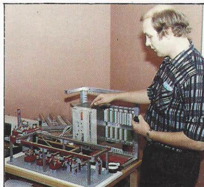
Ing. H. Thorsen demonstrerer en transportmodell styrt av SIMATIC S5-115U.
