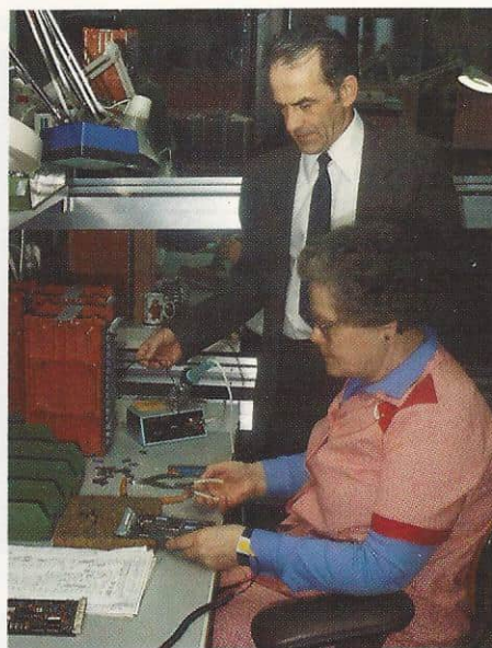
Slik er en arbeidsplass som er sikret mot statiske utladninger. Bordplaten, loddebolten og operatøren som arbeider med de ømfintlige komponentene er forbundet til jord.
