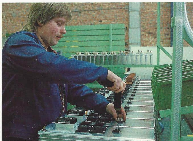
Nye, etterspurte produkter betyr en styrking av vår produktivitet. I Sterkstrømfabrikken er produksjonen av de avbruddsfrie strømforsyninger blitt et viktig innslag. Bildet til venstre viser Harald Krogdal som formonterer kjølere, til høyre Knut Skjemstad som formonterer stativ.
