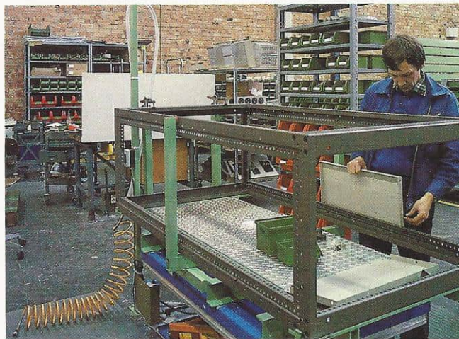
Nye, etterspurte produkter betyr en styrking av vår produktivitet. I Sterkstrømfabrikken er produksjonen av de avbruddsfrie strømforsyninger blitt et viktig innslag. Bildet til venstre viser Harald Krogdal som formonterer kjølere, til høyre Knut Skjemstad som formonterer stativ.
