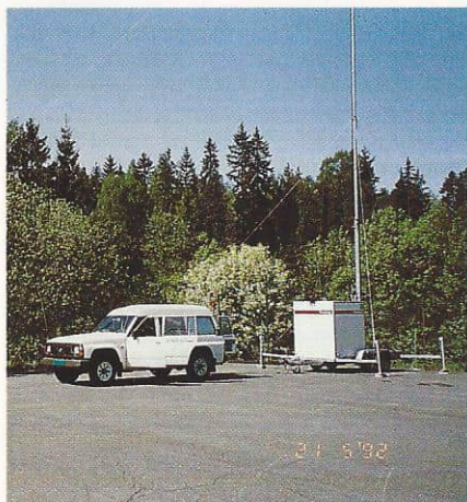
Slik ser GSM-planleggingsbilen ut, med en teleskopmast på 30 meter.
