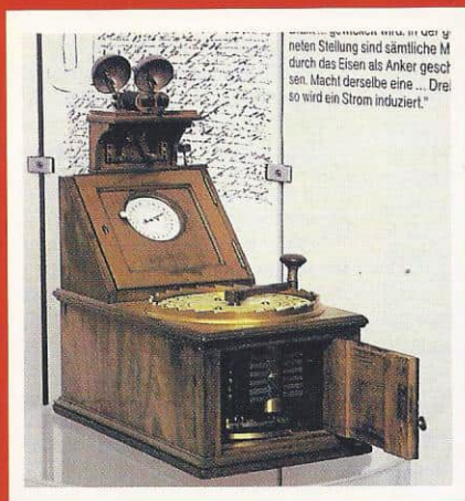
Siemens' første induksjonsapparat fra 1856, forløperen til dynamoen er blant mange historiske milepæler i museet i München. Foto: Siemens.
