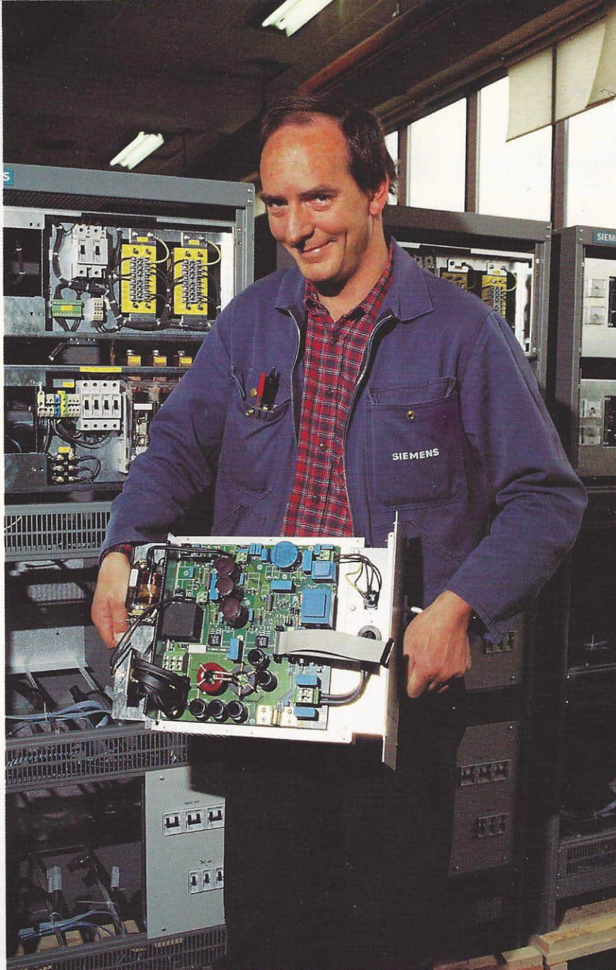
Bjørn Evjen viser frem en likerettermodul til fordelingsskap.
