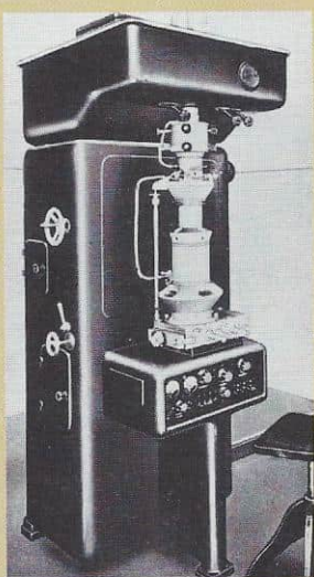
I 1938 serieproduserte Siemens dette elektronmikroskopet, utviklet av E. Ruska og B.v. Borris (Forstørrelse 30.000 ganger)
