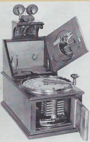
Magnet-elektrisk visertelegraf med sveiveinduktor, 1856. I nedre del kan magnet-induktoren - med dobbelt T-anker - sees.
