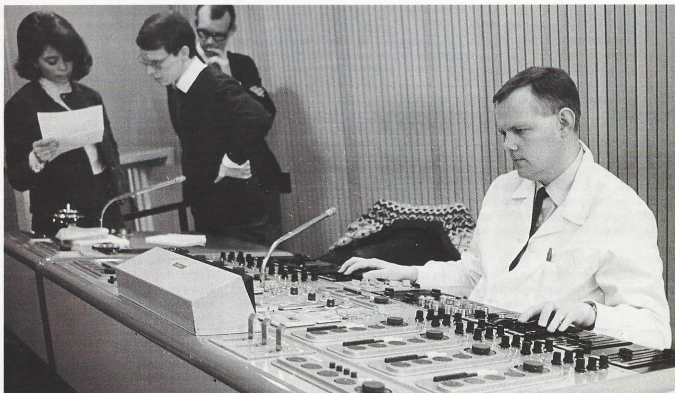
Roger Arnhoff bak spakene på mikserbordet under opptak av Wenche Myhres første single i stereo. Mikserbordet, som hadde seks kanaler, bygget han selv.
