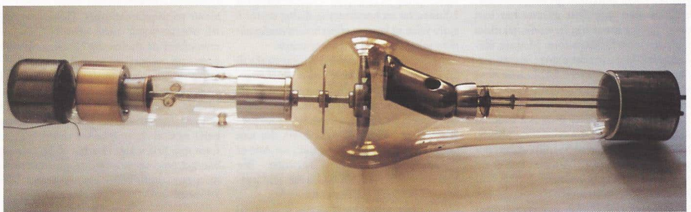
Dette er kanskje det mest berømte røret av alle, Siemens PANTIX - dreieanoderør, produsert første gang i 1933
