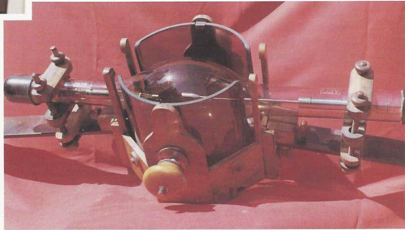
Røntgenrør produsert av Siemens etter år 1900 med den berømte røntgenkulen. Ved siden av røret som utgjorde «innmaten».
