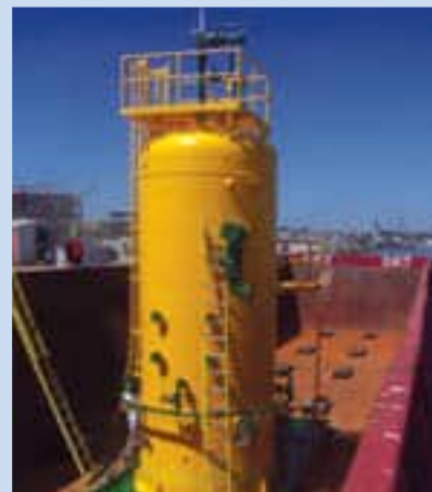
RENSER VANN: Bildet viser vannbehandlingsutstyret som blir en del av prosessanlegget for oljeproduksjon på Golfinho-feltet i Brasil.
