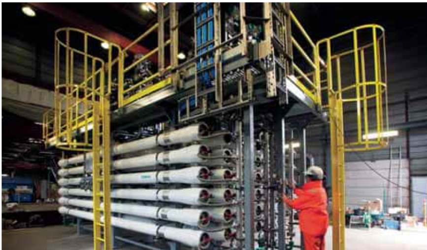
RENSER VANN: Ved oljeproduksjon pumpes det ofte inn sjøvann i reservoaret for å opprettholde trykket for å få ut mer olje. Det kan det dannes salter som fører til avleiringer som kan tette reservoaret og rørene som oljen skal strømme opp i. Dette unngås med sulfatfjerning som foregår ved at vannet kjøres gjennom et membranlegg som vist på bildet.
