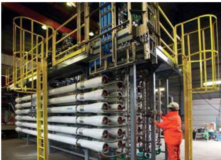
TOTAL GARANTI: SOGO skal stå for den totale prosessgarantien innen vannrensing av sjøvann til re-injeksjon ved oljeproduksjon på den nye P55-plattformen utenfor Brasil. Bildet viser en sulfatfjerningspakke bygd i Halden i fjor.
