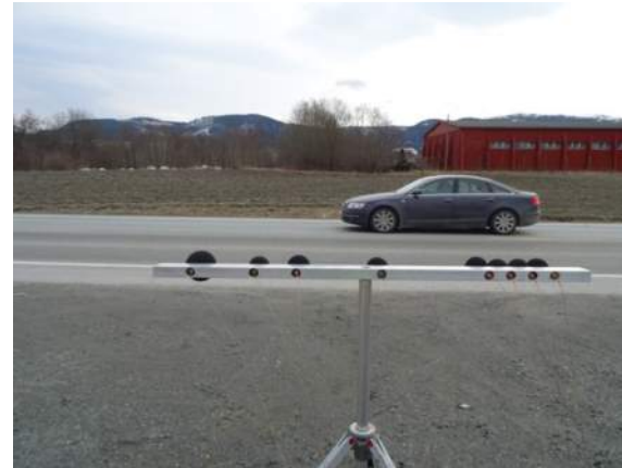
Mikrofonarray (deteksjon av enkeltkjøretøy i tett trafikk)
