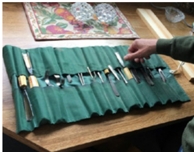
Treskjærerjern er gjerne kvasse som barberblad og slipes med heiner med ulik finhet, til slutt mot lærreim.
