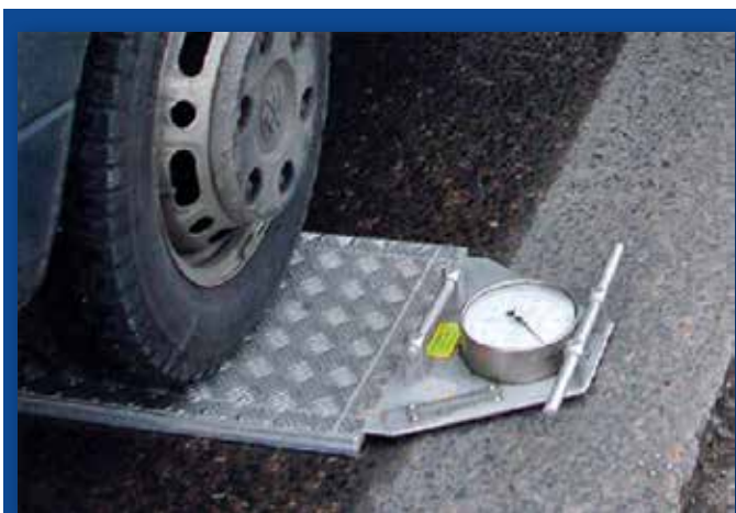
En type mobile vektor som kan brukes på kontroll. Det opplyses at de har med vektor til alle hjul som veies samtidig. Det er ikke avrunding ned til nærmeste 100 kg på alle disse, men pr. aksel og OBS på LI på dekket.
