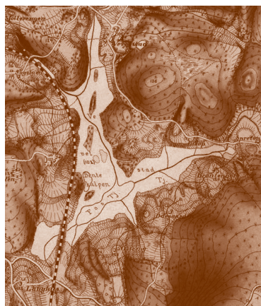
Kartet fra 1883 viser oppdemningen av sagdammen/Vevelstadsaga. Bildet er omtrent identisk med dagens flomkart ved en 200-årsflom.
